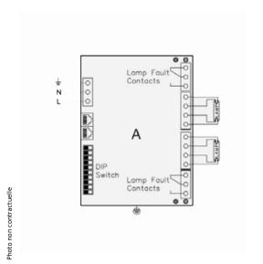
Ballast Electronique pour tube Germicide UVC 2x300w 2x320w 198-264v
